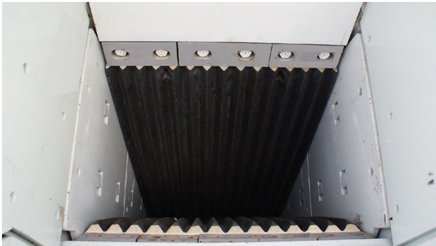
Optimierte Brechraumgeometrie mit langen Brechbacken
