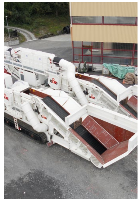
B 1185 FDR PB mit elektrischem Antrieb, Plattenband und Filteranlage für den Tunnelleinsatz
