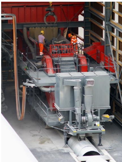
B 1410 raupenmobil mit Plattenbandaufgabe im Hartgestein ( 3'900 \text{ kg/cm}^2 )
