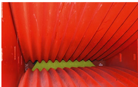
Abweisblech zur Schonung der Förderbandgurte
