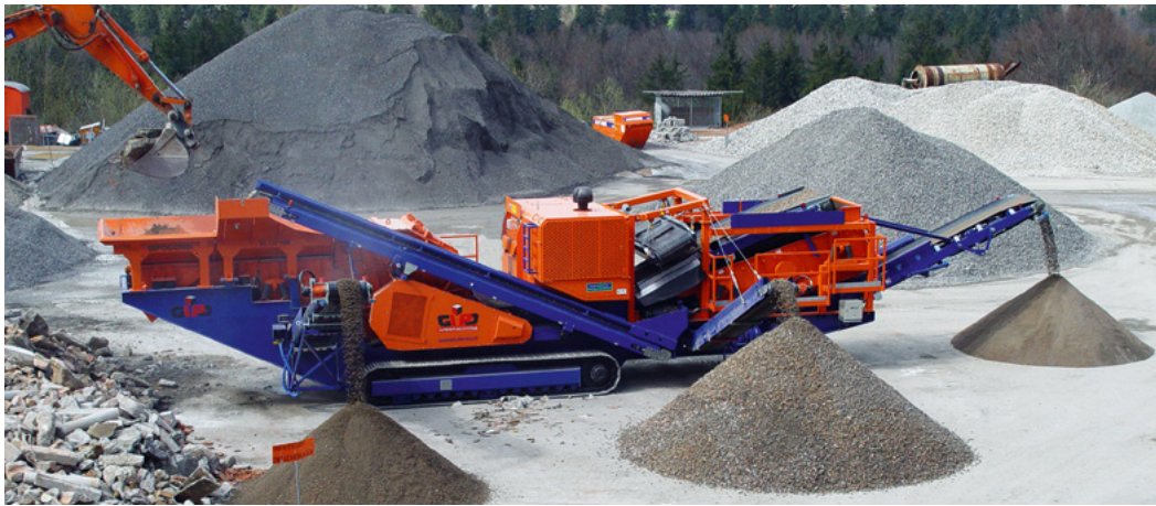
Brechen und Sieben auf einer Anlage/Crushing and screening with one plant/Broyage et criblage avec la même installation
