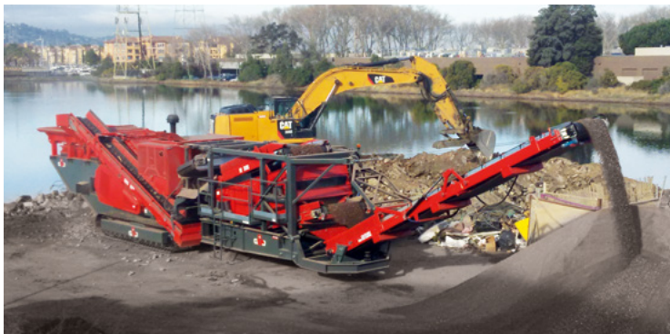
GIPOKOMBI RC 130C mit schwenkbarem Austragsband / with pivoting discharge conveyor / avec tapis d'évacuation pivotant
