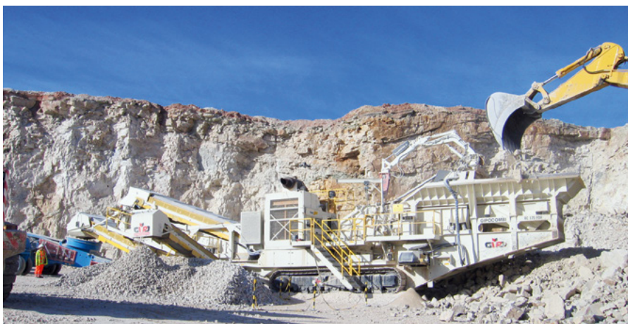
RC 170 FDR mit einer Leistung bis 1100 t/h/with a capacity of up to 1100 t/h/avec une capacité allant jusqu'à 1 100 t/h
