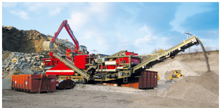
GIPOKOMBI RC 131 FDR mit Kombiantrieb / with combined drive / avec entraînement combiné
