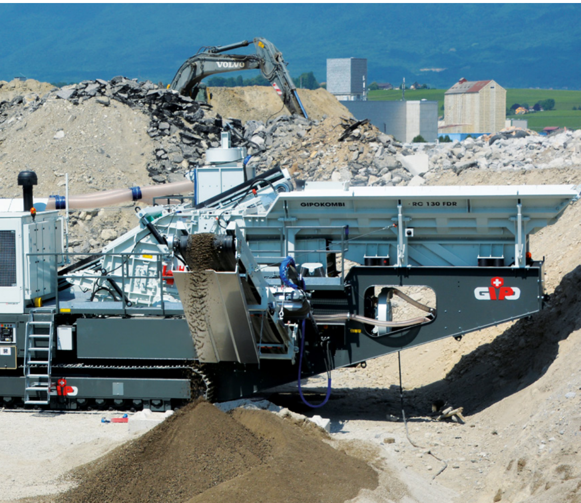
GIPOKOMBI RC 130 FDR mit Windsichtung, Eisen-austrag in Längsrichtung und Eisenaustrag mittels Magnettrommel / with air separator, iron output in direction of the material flow and iron output by means of a magnetic drum / avec séparation à air, déferrailleur dans le sens longitudinal et déferrailleur avec tambour magnétique
