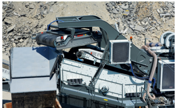
Eisenaustrag in Längsrichtung mit absenkbarem Permanent- magnet / Iron output in the direction of the material flow with permanent magnet / Déferrailleur dans le sens longitu- dinal avec aimant permanent pouvant être abaissé
