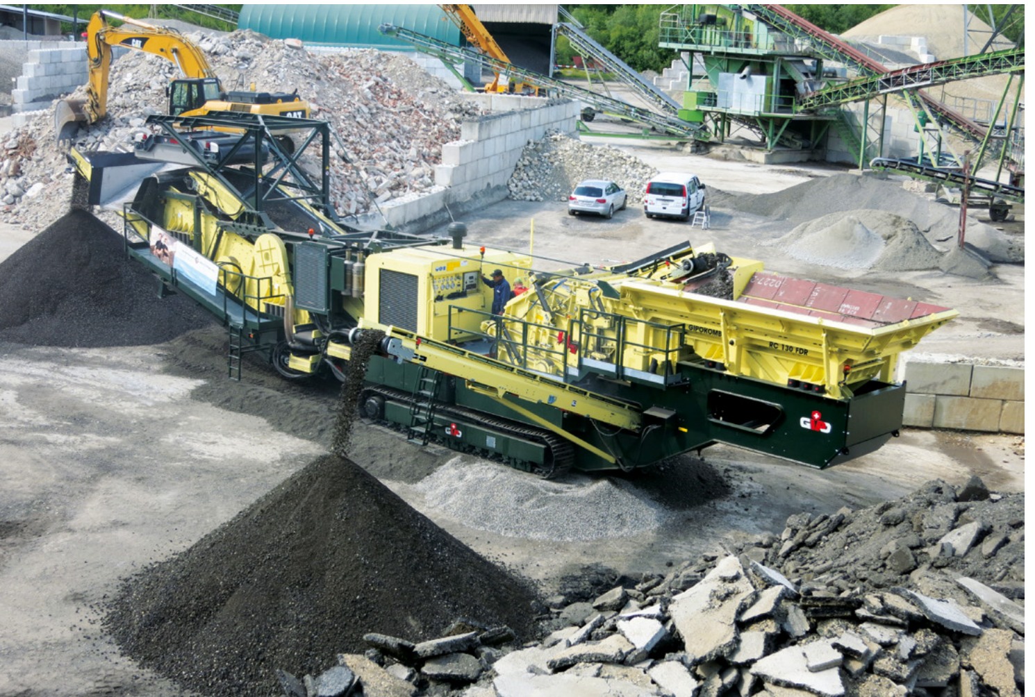
GIPOKOMBI RC 130FDR mit Magnet oben in Längsrichtung / with upper magnet in direction of the material flow / avec aimant supérieur dans le sens longitudinal
