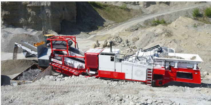
Direktantrieb und Eisenaustrag in Längsrichtung / Direct drive and iron output in the direction of the material flow / Entraînement direct et déferrailleur dans le sens longitudinal
