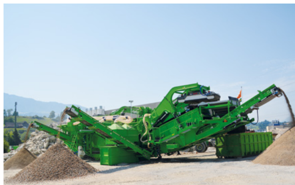
GIPOKOMBI RC 130 FDR mit Windsichtung, Filtereinheit (Staub), Eisenaustrag in Längsrichtung und 3-Deck Siebeinheit / with air separator, filter unit (dust), iron output in the direction of the material flow and 3 deck screening unit / avec séparation à air, unité de filtrage (poussière), déferrailleur dans le sens longitudinal et unité de criblage à 3 niveaux
