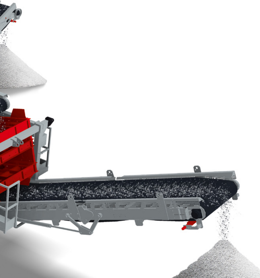
Eisenaustrag im Seitenbandvorsieb / Iron output with a side-conveyor pre-screen / Déferrailleur dans le tapis latéral précriblage
