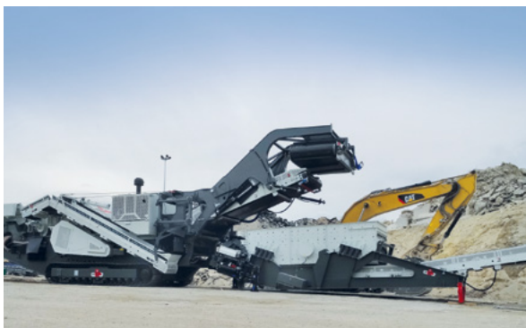
GIPOKOMBI RC 130 FDR mit abnehmbarer 3-Deck Siebeinheit / with removable 3 deck screening unit / avec unité de criblage amovible à 3 niveaux
