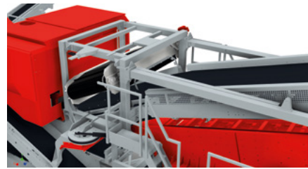
Eisenaustrag quer / Transversal iron output / Déferrailleur dans le sens transversal
