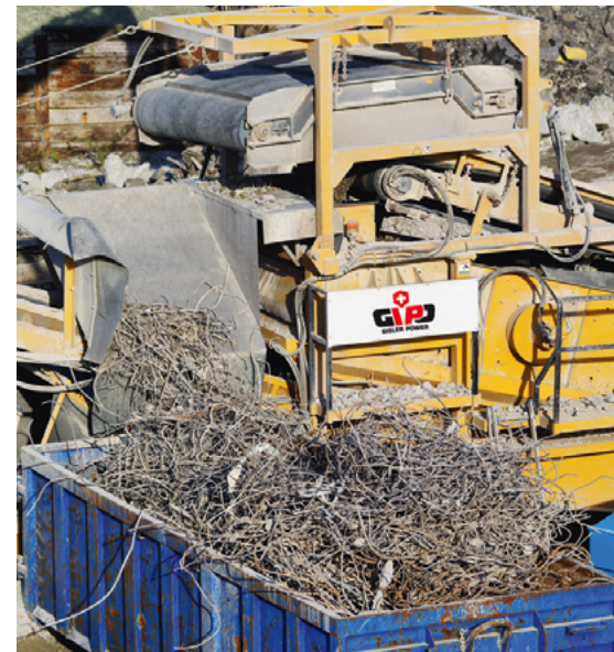
Eisenausrag in Flussrichtung mittels sehr starkem Permanentmagnet/Iron output in the direction of the material flow using a very strong permanent magnet/Déferrailleur dans le sens de l'écoulement grâce à un aimant de très forte puissance
