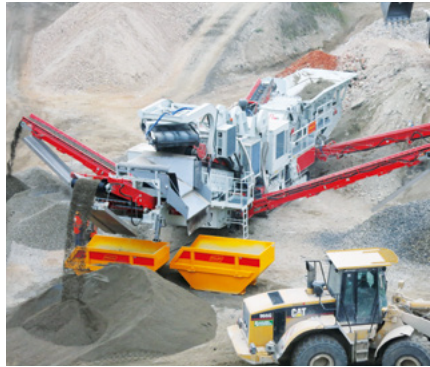
GIPOKOMBI RC 110 FDR mit Windsichtung und 3-Deck Siebeinheit / with air separator and 3 deck screening unit / avec séparation à air et unité de criblage à 3 niveaux
