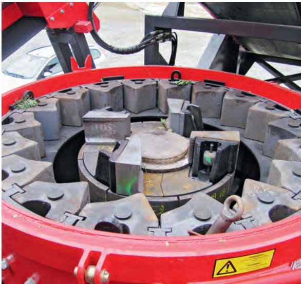
Drehtisch mit Schleuderplatten und Aussenring mit Prallplatten
