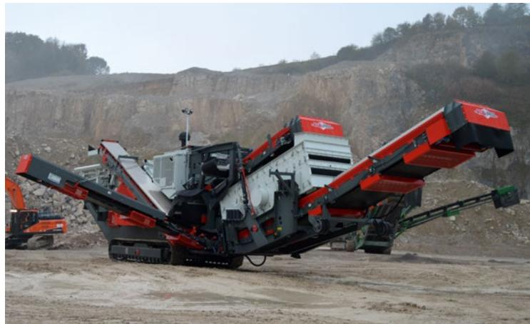
3-Deck GIGA-Siebenheit / 3 Deck Screening unit / Cribleur à 3 étages
