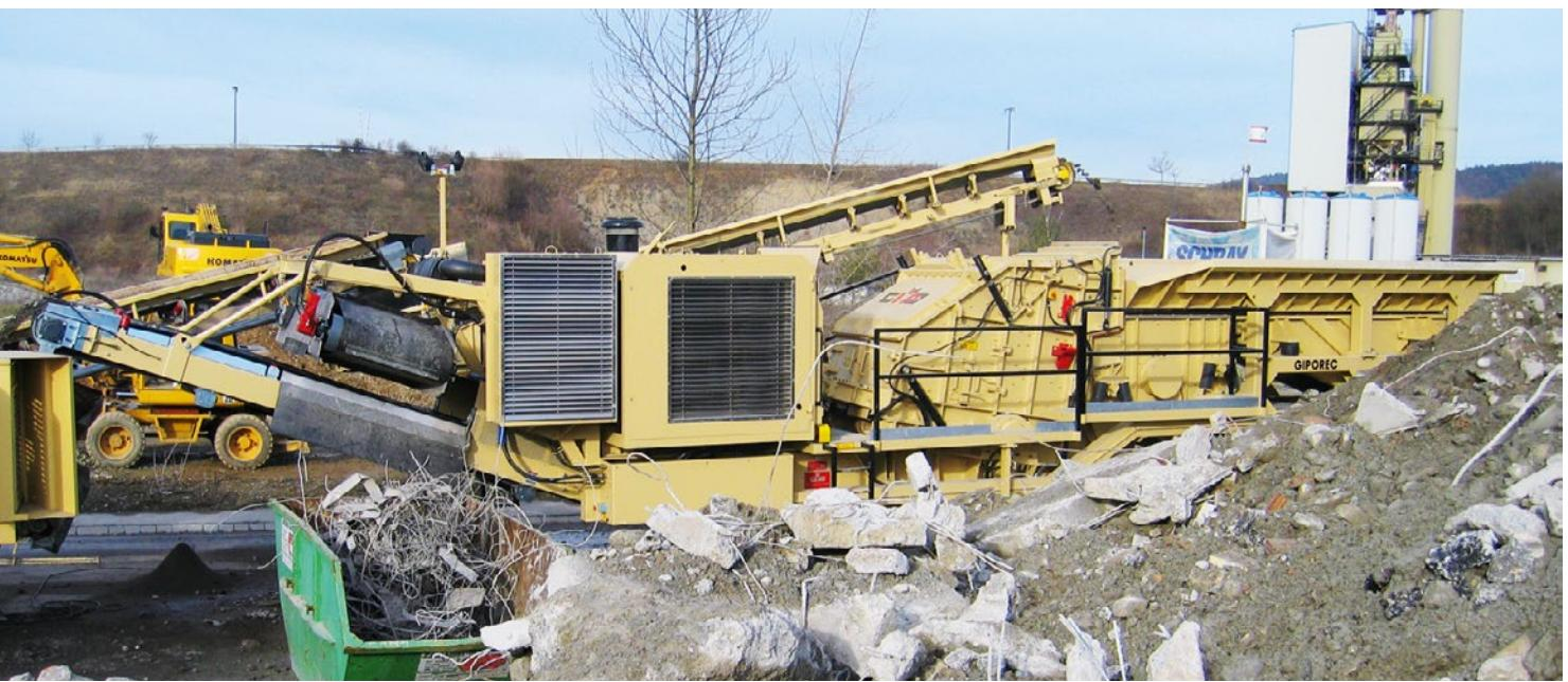
GIPOREC R130 FDR Einsatz im stark armierten Betonabbruch /for heavily reinforced concrete /Utilisation pour les déchets de béton fortement armé
