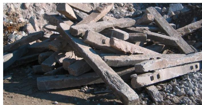
GIPOREC R 150 C spezial Brechen von Bahnschwellen mit langer Federstahlarmierung /for crushing of sleepers with long spring steel reinforcements / Broyage de traverses avec de longues armatures en acier à ressort
